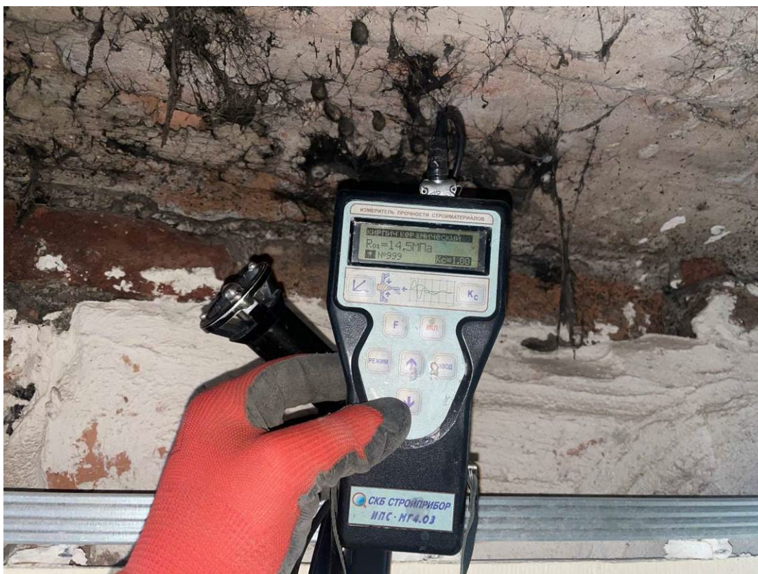
Фото 17. Определения прочности кирпича кирпичной кладки стен
